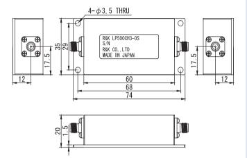
■ Passband Frequency : DC ~ 500MHz ■ Insertion Loss : 1.0dB (max.) ■ VSWR : 1.3 (typ.)
